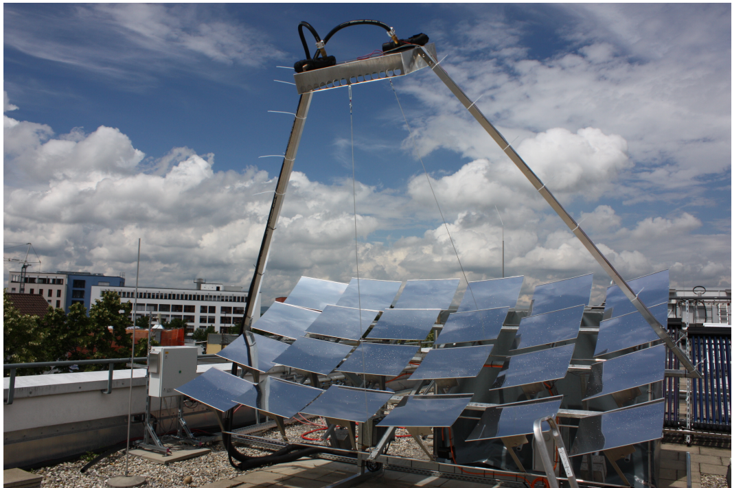
Figure 2: Fotografie des Kollektors während der Testphase - Picture of the collector while testing
